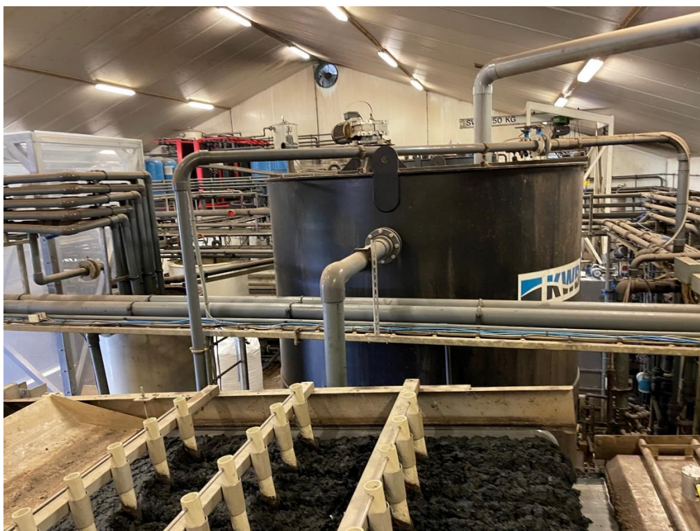
Aufgabe der frischen Gülle auf die Siebbandpresse (einziger spürbarer Emissionsbereich der Anlage)
